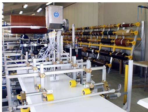
kašírování panelů fólií
